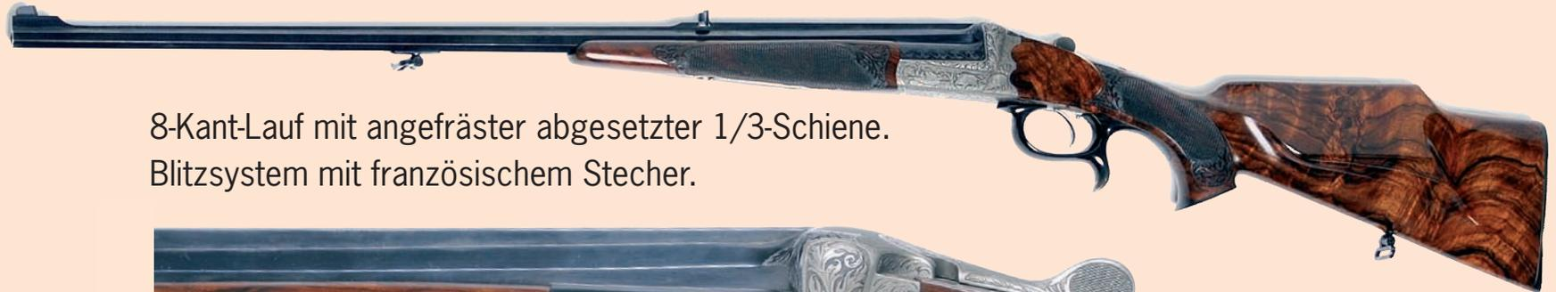
8-Kant-Lauf mit angefräster abgesetzter 1/3-Schiene.
